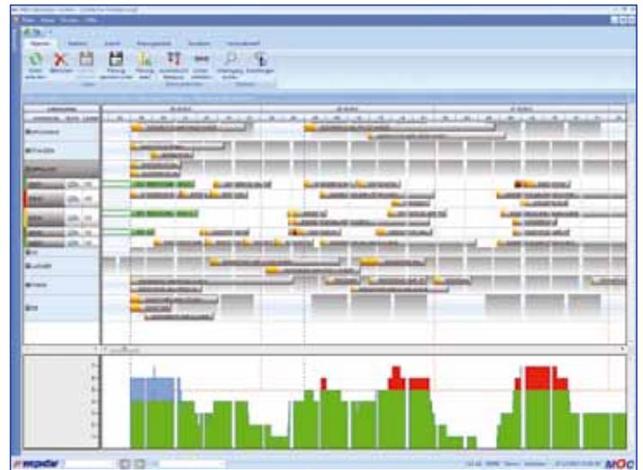
Der HYDRA-Leitstand ermöglicht eine exakte Beurteilung der Planungsergebnisse. Die Auslastungsgrafik zeigt auf, zu welchem Zeitpunkt freie Fertigungskapazitäten verfügbar sind und wo Überbelegungen eine Umplanung erfordern.
