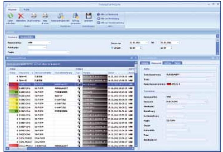
In der Funktion „Ressourcenhistorie“ wird der gesamte Lebenslauf eines Werkzeugs übersichtlich dargestellt. Manuelle Aufschreibungen entfallen, denn die Daten können bei Bedarf als Werkzeugbuch ausgedruckt werden.
