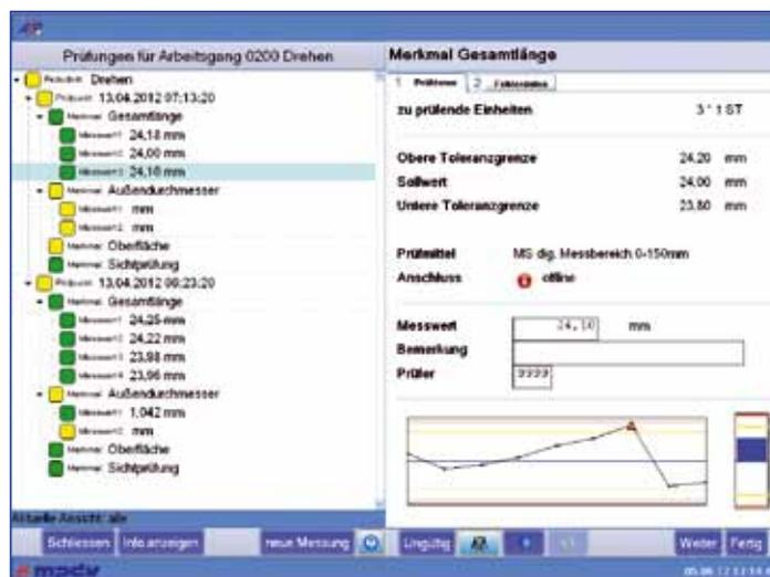
Die Erfassung der Prüfdaten kann an Prüfstationen oder vorhandenen BDE-Terminals erfolgen. Die automatische Führung durch den relevanten Prüfplan und der Anschluss von Messmitteln oder Prüfeinrichtungen vereinfacht die Prüfvorgänge und verhindert Fehleingaben.
