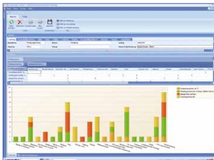
Die Fehlerschwerpunktanalyse zeigt eine klassifizierte Übersicht der aufgetretenen Qualitätsprobleme, wobei die Form der Darstellung frei wählbar ist (z.B. Pareto-Analyse, Linien-, Torten- oder Balkendiagramm).
