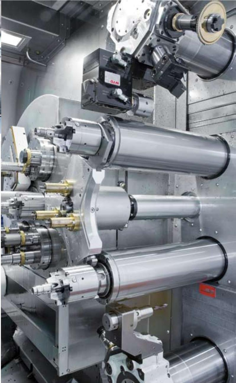
Zweitseitenbearbeitung mit drei vollwertigen zusätzlichen Spindeln und bis zu acht Werkzeugen
