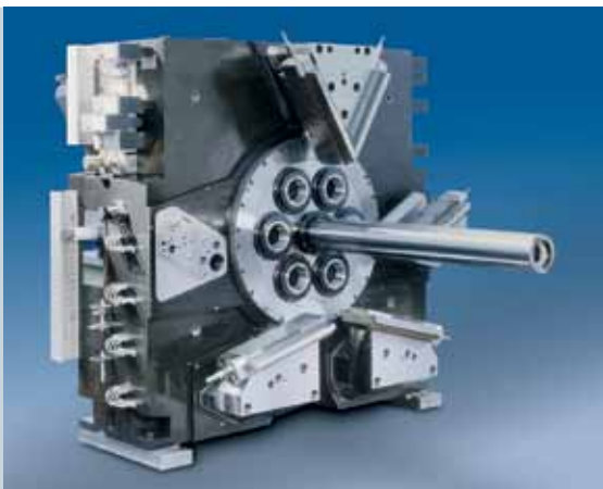
Spindelkasten mit Querschlitten und Spindeltrommel
