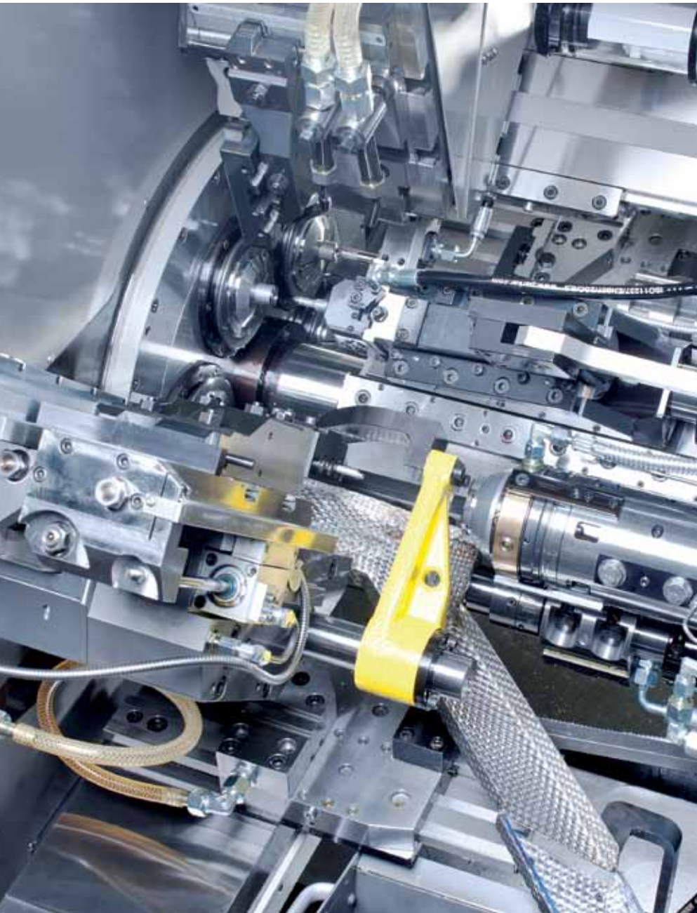
Zerspanungsraum eines Sechsspindel- Drehautomaten der Baureihe PC
