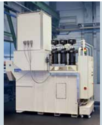
Kühlschmierstoff- Aufbereitungsanlage mit Vollstromfilter und Kühlung (optional)
