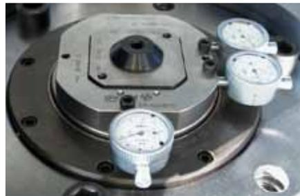
Mit Hilfe des speziell entwickelten Ausrichtsets werden die Spannfutter präzise zueinander ausgerichtet. Es sind keine weiteren Justierungen notwendig.
