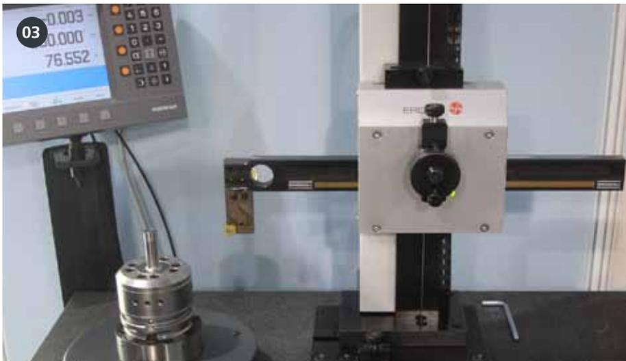
Die Palette wird auf dem Ausrichtgerät pneumatisch gespannt – Repetiergenauigkeit <math>< 0.002\text{ mm}</math>.
