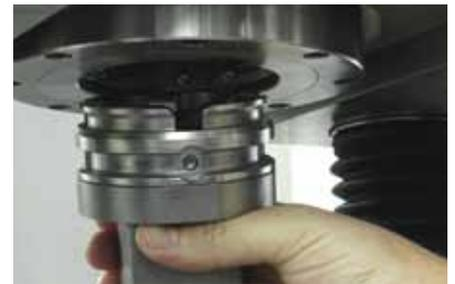
Stempel und Matrizen können in der Folge schnell und präzise gespannt und ausgewechselt werden. Die Repetiergenauigkeit beträgt  $< 0.002$  mm.
