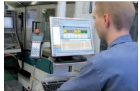
Auf der in ergonomisch richtiger Arbeitshöhe angeordneten Beladestation stellt der Operator die Paletten bereit. Per Knopfdruck lässt er dann den Roboter den gerüsteten Job abholen und auf einen freien Platz im Magazin ablegen.
