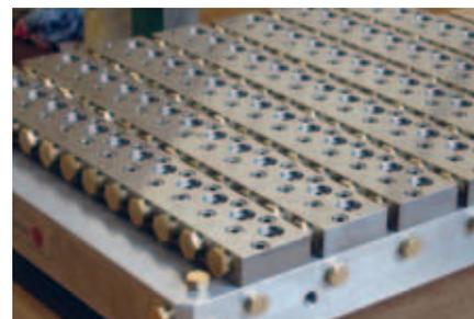
MTS Palette mit hydraulischen Spannelementen.
