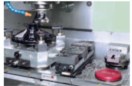
Verschiedene Aufträge auf einer Maschine. Das Umrüsten der Spannmittel erfolgt in wenigen Sekunden.
