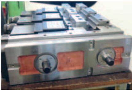
Bestehende Schraubstücke, Lehren und Aufspannvorrichtungen werden mit Spannzapfen bestückt oder palettiert und sofort weiterverwendet.
