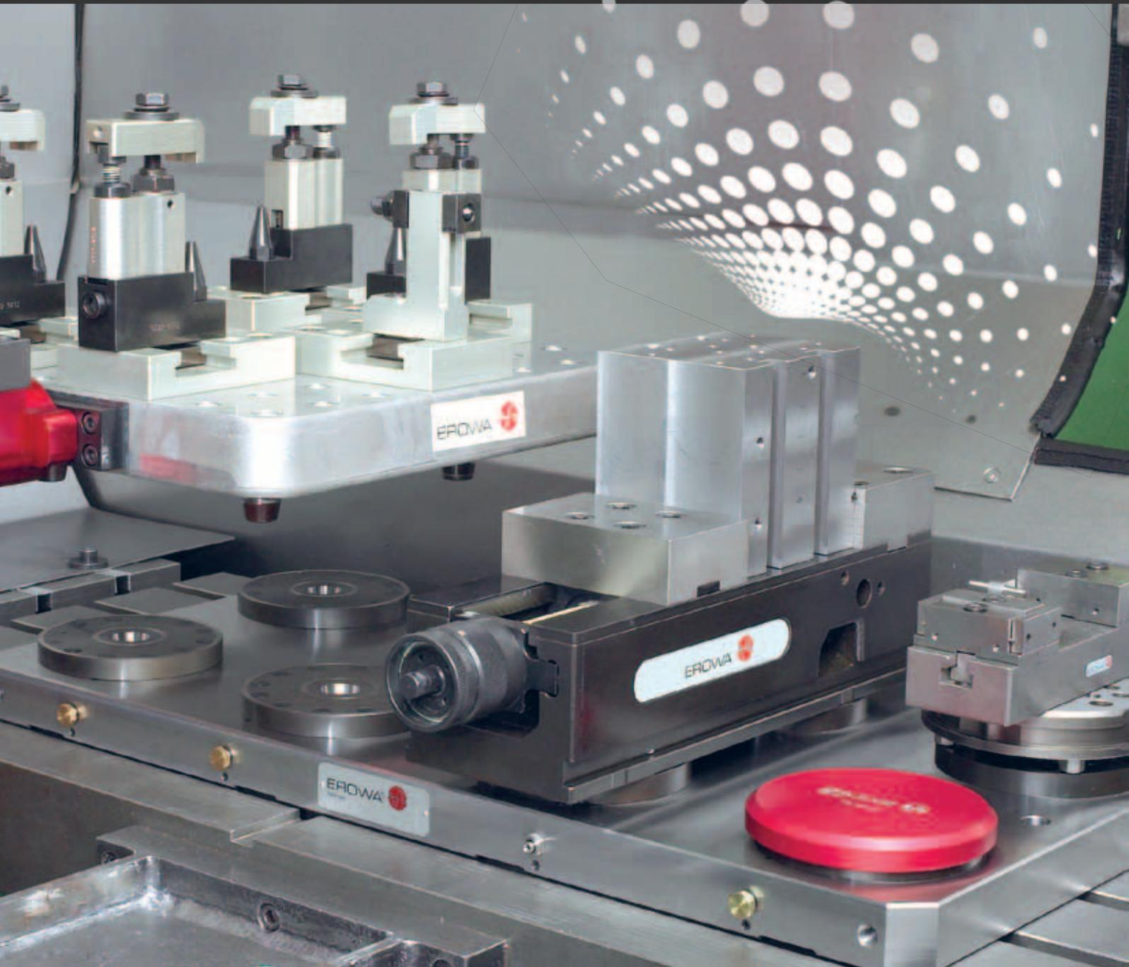
EROWA MTS (Modular Tooling System) ist ein offenes Spannsystem. Für den Einsatz bieten sich verschiedene Möglichkeiten: Einzelpalettierung mit einem MTS Spannfutter, oder Mehrfachpalettierung mit mehreren MTS Spannfütern. Die MTS Spannfüter werden direkt auf den Maschinentisch montiert oder in Basisplatten integriert.
