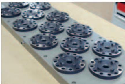
Basisplatte mit 13 MTS Single Spannfütern.
