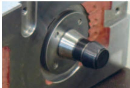
Die Zentrier- und Ausgleichszapfen positionieren und zentrieren den Werkstückträger hochpräzise in den MTS Spannfütern.
