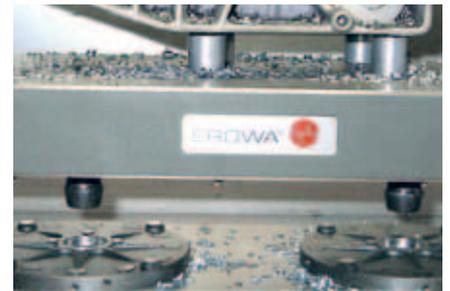
Beim Werkstückwechsel werden die Auflageflächen der MTS Spannfüter automatisch gereinigt. Die MTS Palette wird sauber und präzise positioniert.
