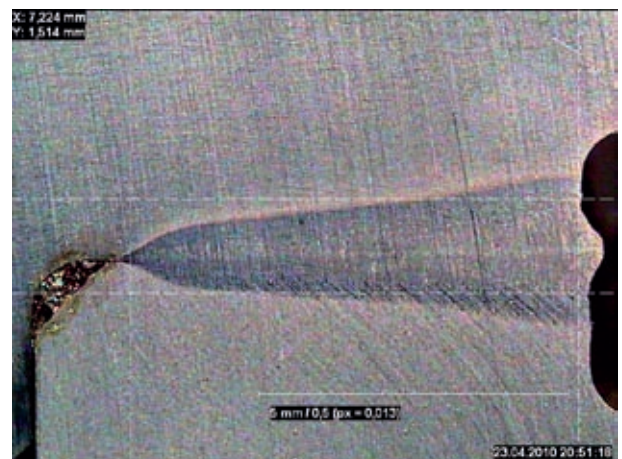
Querschnitt zur Beurteilung der Schweißnaht-Qualität.
