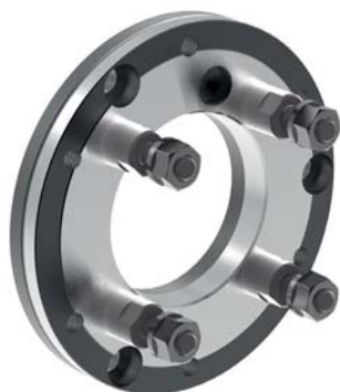
CAPTIS-M Zwischenflansch nach DIN ISO 702-3 (DIN 55027) mit Stehbolzen und Bundmutter / Zylindrische Aufnahme futterseitig nach DIN6350
