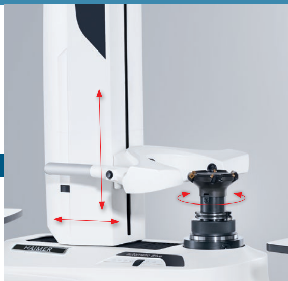
Vollautomatische, bedienerunabhängige Werkzeuvoreinstellung und -vermessung Fully automatic tool presetting and measurement independent of the operator
