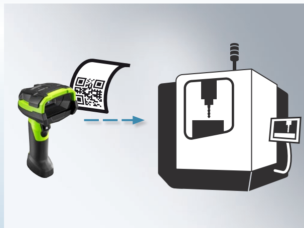
Das an der Maschinensteuerung angeschlossene HQR-System liest den QR-Code und übermittelt die Werkzeugdaten direkt in die Steuerung der Maschine/The HQR system is connected to the control system of the machine. It reads the QR code and transmits the tool data directly to the control system
