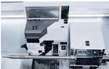
■ Dreh-Fräs-Bohrkopf und Bohrstangenschlitten
