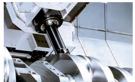
■ Dreh-Fräs-Bohrkopf für Schwerzerspannung
