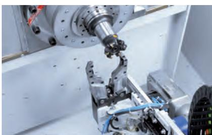
■ Getrennter Werkzeugwechsel für zweiten Schlitten
