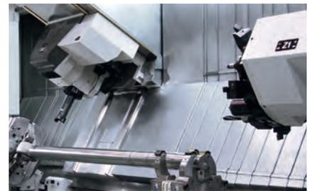
■ Dreh-Fräs-Bohrkopf und Werkzeugträger
