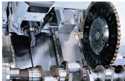
■ Dreh-Fräs-Bohrkopf und Außenfräseinheit
