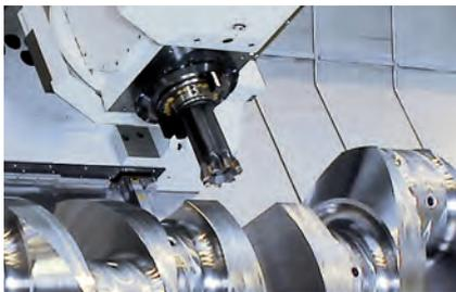
■ Universal Dreh-Fräs-Bohrkopf
