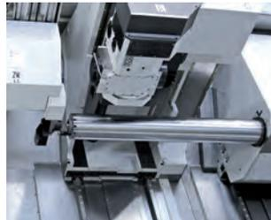
■ Innenbearbeitung mittels Bohrpinoles
