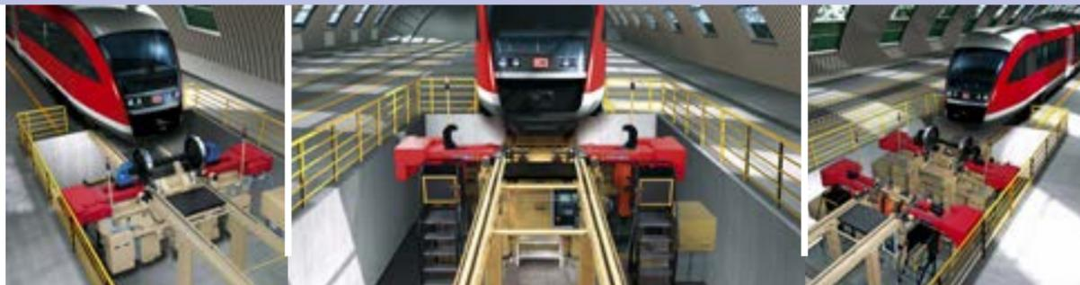
Mobile Radsatzdrehmaschine Mobiturn® 2
