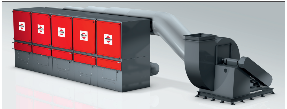
Zentrale Abscheidestation, bestehend aus fünf AERO®-Modulen der Baugröße 3 und einem Ventilator (Nennluftmenge 64 000 m³/h)
