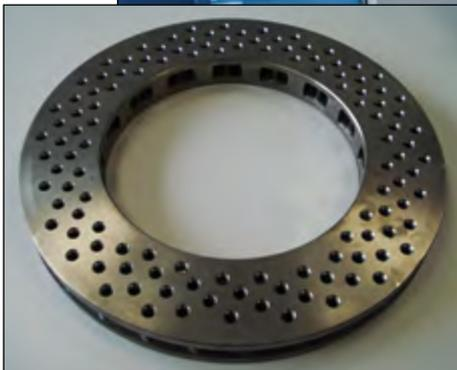
*Perforieren, Duppen und Befräsen von Bremsscheiben*
