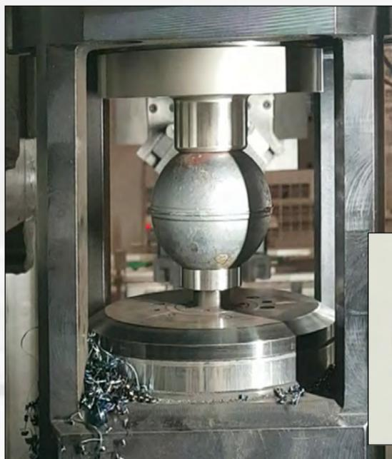
Kugel  $\varnothing 70$  als Rohteil, gespannt auf Nord- und Südpol, und fertig bearbeitet
