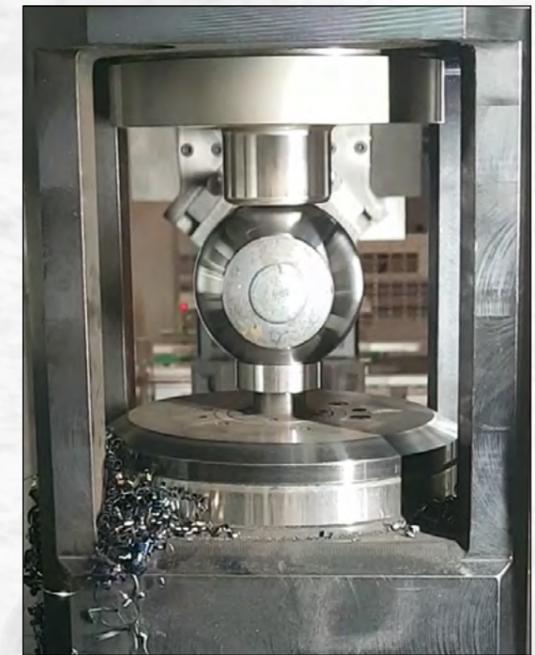
Drehen von Kugeln mit einer Rundlaufgenauigkeit im Mikrometerbereich
