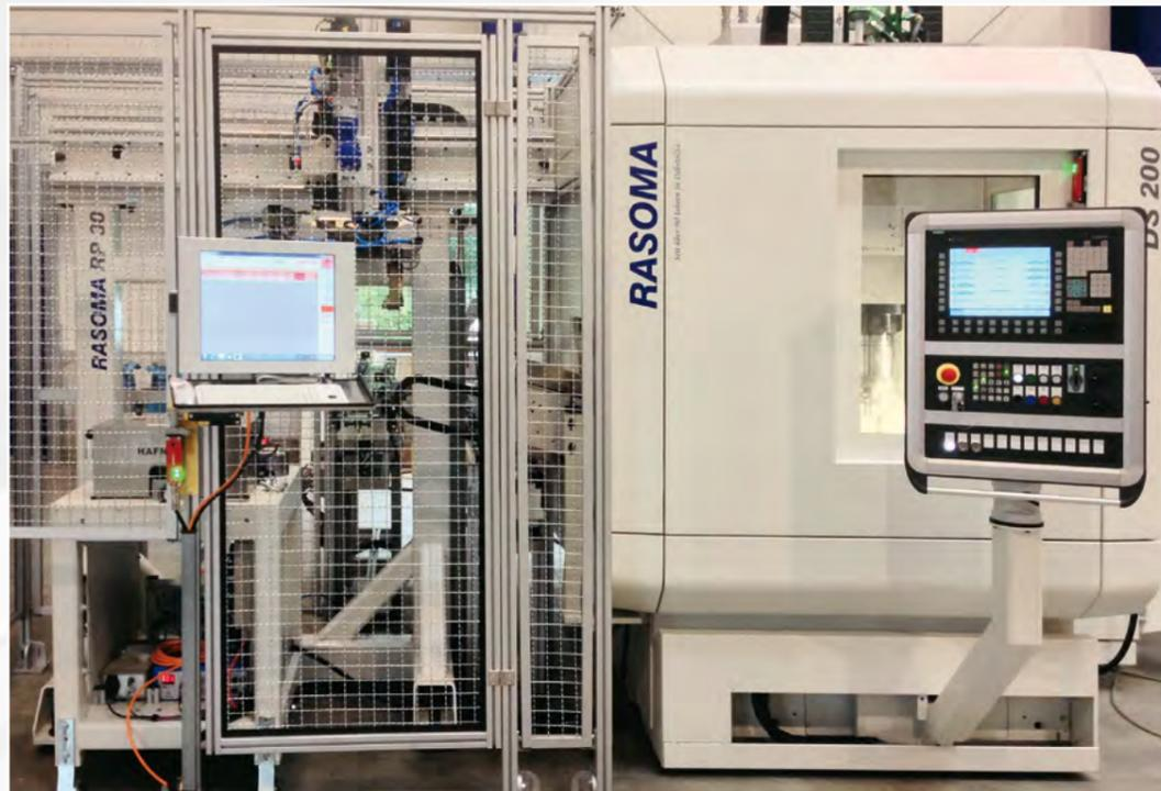
DS 200 mit Werkstückzu- und -abführband, RASOMA-Portal RP 30 sowie externer Messstation (Farbgebung gemäß Lastenheft)
