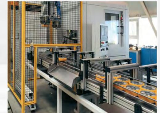
DS 100 zur Bearbeitung von Laufrädern bis Durchmesser 300mm
