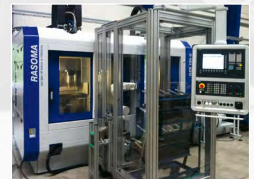
Gelenkarmroboter zur Be- und Entladung sowie zur Beschickung von Messstation, SPC-Rutsche und Fertigteilstapelndornspeicher
