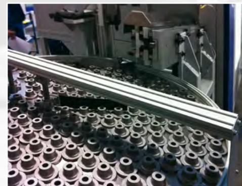
Tellerspeicher für Roh- und Teleskopschlitten mit Übersetzer
