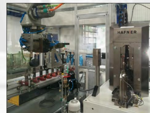
Maschinenintegriertes RASOMA-Knickarm-Ladeportal und Messstation
