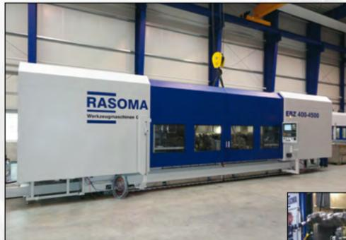
RASOMA Endenbearbeitungszentrum EBZ 400-4500 für wellenförmige Teile bis 4.500mm Länge
