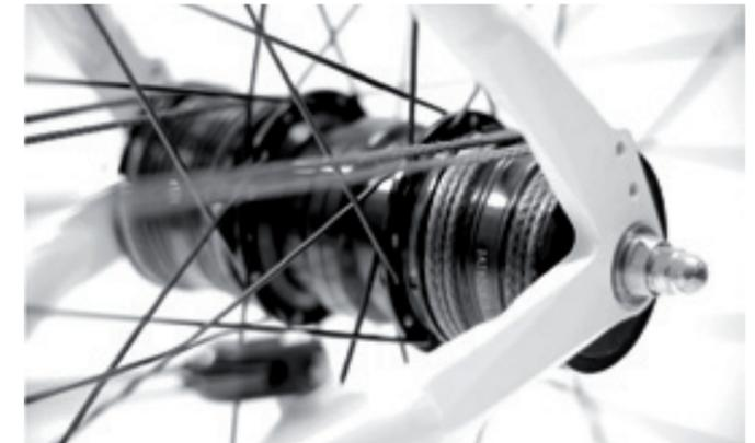
Übersteigt die Geschwindigkeit der Abtriebsseite die Drehzahl des Antriebs, entkoppelt der Freilauf (An- und Abtrieb) und wechselt vom Kraftschluss in den Leerlauf.
