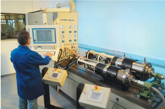
Vor Auslieferung der GMN Maschinenspindeln für die Hochgeschwindigkeitsbearbeitung (HSC), werden diese auf einem speziell für GMN entwickelten Prüfstand getestet.
