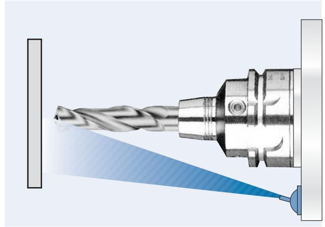
Zur Kühlung von Werkzeug und Werkstück wird das Medium durch das Spindelgehäuse und Düsen an die Bearbeitungsoberfläche gebracht.
