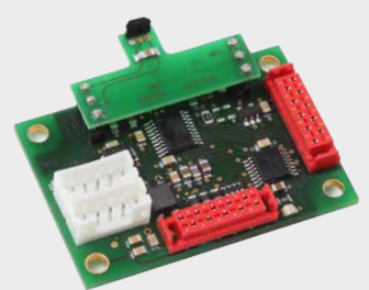
Messplatine mit Magnet-Sensor (Messkopf)
