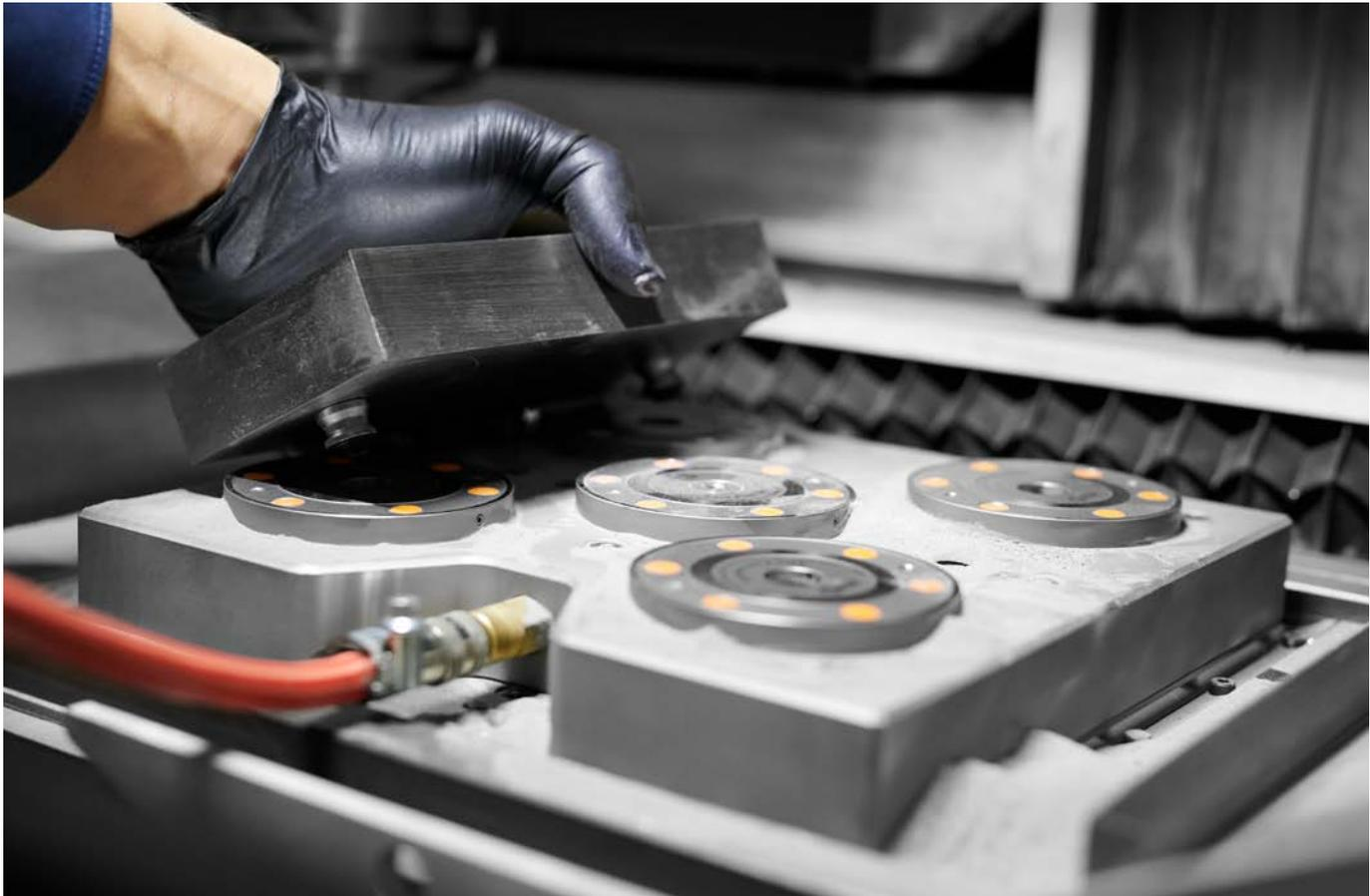
AMF-Zero-Point-Systems in der additiven Fertigung.
