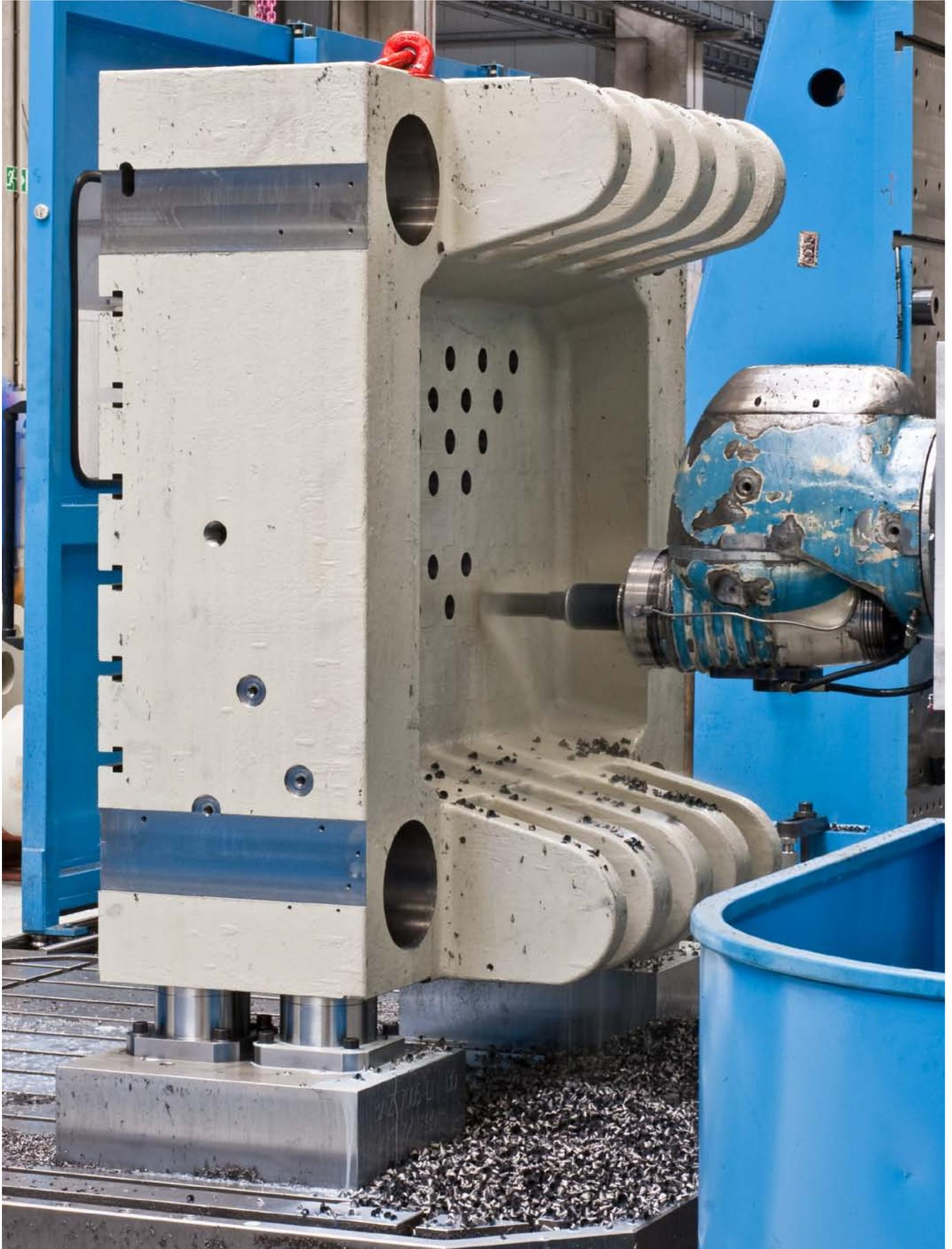
Nullpunkt-Spannkonsolen im Einsatz in der Schwerzerspannung.
