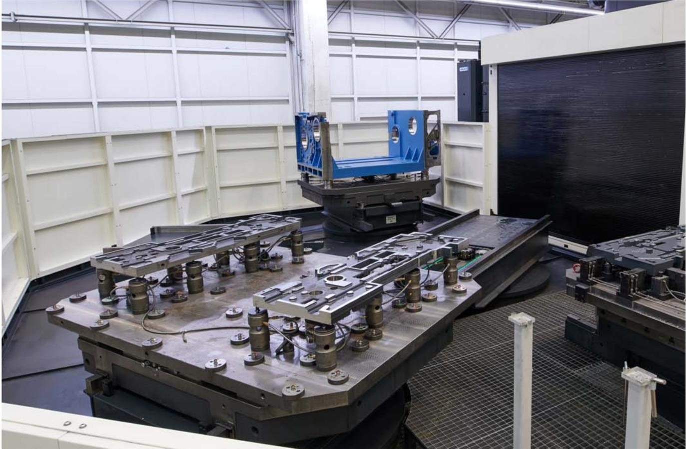
Die Nullpunktspanntürme werden durch einfaches Umsetzen an das jeweilige Werkstück flexibel angepasst.
