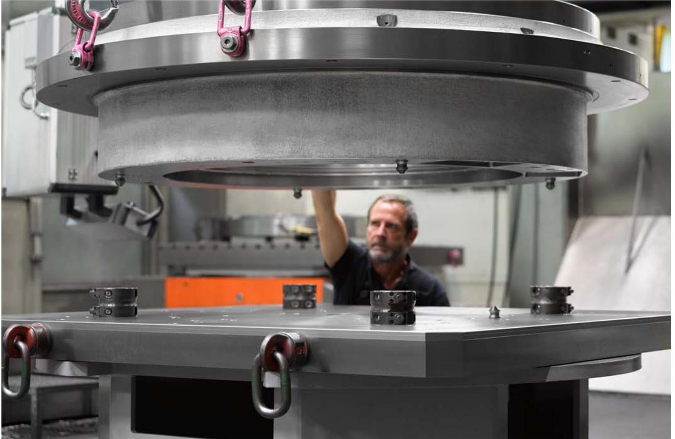
Rüstzeitoptimierung in der Kleinserienfertigung durch eine variable Bauteildirektspannung.
