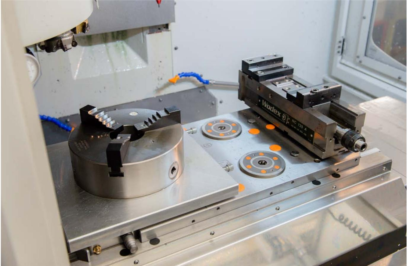
8-fach-Spannstation zur Aufnahme verschiedenster Standard-Spannmittel bzw. Werkstückdirektspannung.
