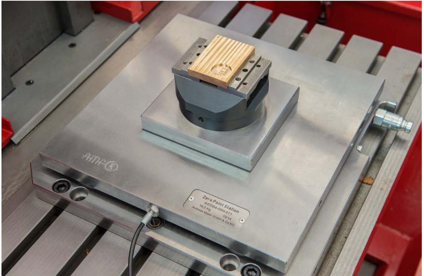
Das AMF-Zero-Point-System bildet hier die einheitliche Schnittstelle zwischen mehreren Maschinen. Das Werkstück kann größenunabhängig so auf den verschiedenen Maschinentischen rüstzeitoptimiert gespannt werden.
