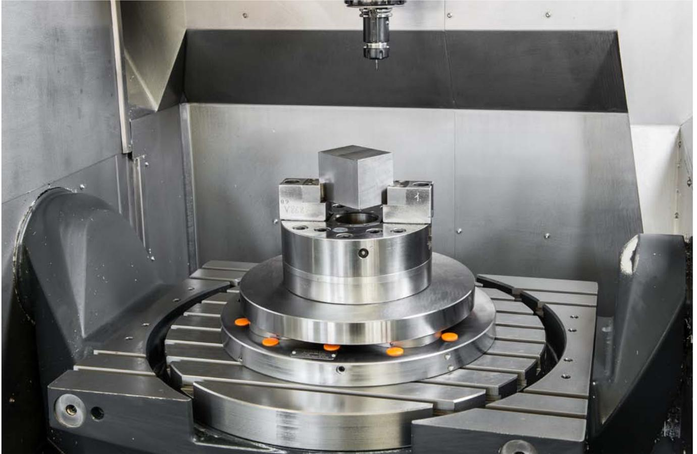
4-fach-Spannstation mit integrierter Auflagen- sowie direkter Verriegelungskontrolle für den Einsatz auf Fräs-Drehmaschinen bis zu einer maximalen Drehzahl 2200 U/min.
