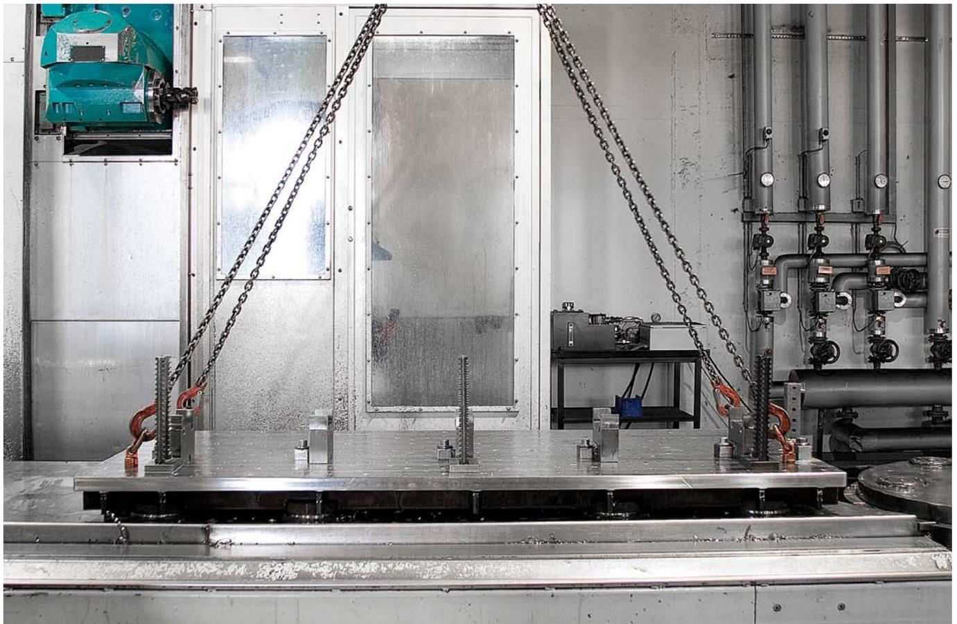
Durch den zylindrischen Aufbau der Spannbolzen sowie der Aufnahme im Spannmodul ist ein Ausgleich von Höhen- und Längstoleranzen auch auf große Distanzen gewährleistet.
