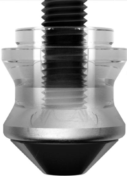
> Der Spannbolzen ist bei unserem Zero-Point System die Schnittstelle zwischen dem Maschinentisch und dem Werkstück bzw. der Vorrichtung. Er gewährleistet ein exaktes Positionieren und sicheres Spannen. Die entstehenden Bearbeitungskräfte werden über den Spannbolzen auf das Spannmodul übertragen.
