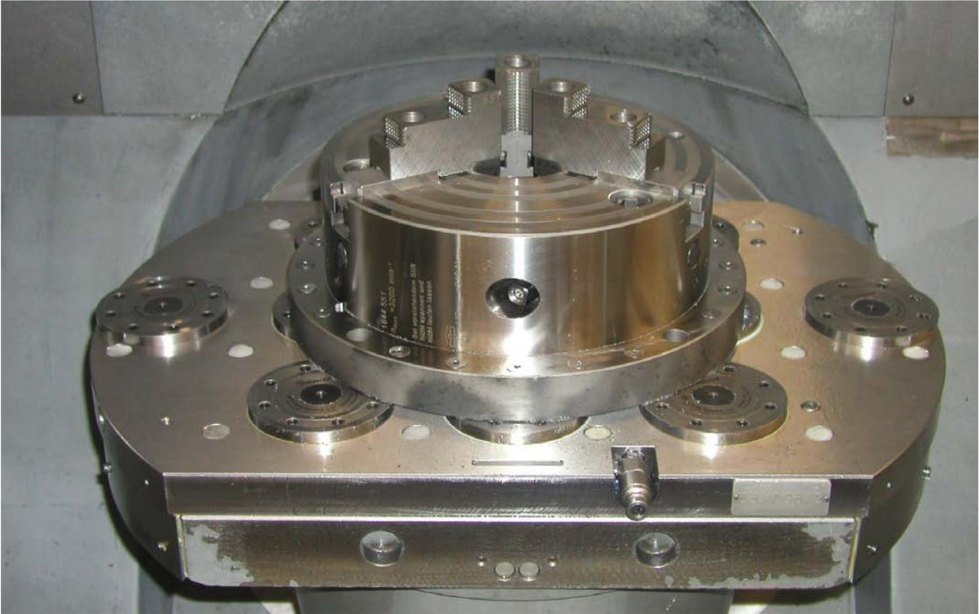
Einfacher Wechsel eines 3-Backenfutters mittels des AMF-Zero-Point-Systems.
