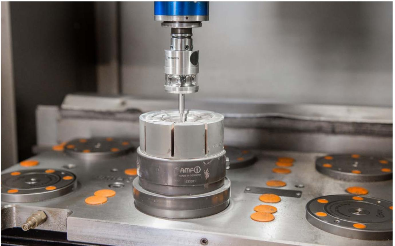
Die mechanische Spannzanze wird direkt per Nullpunktspanntechnik gespannt.
