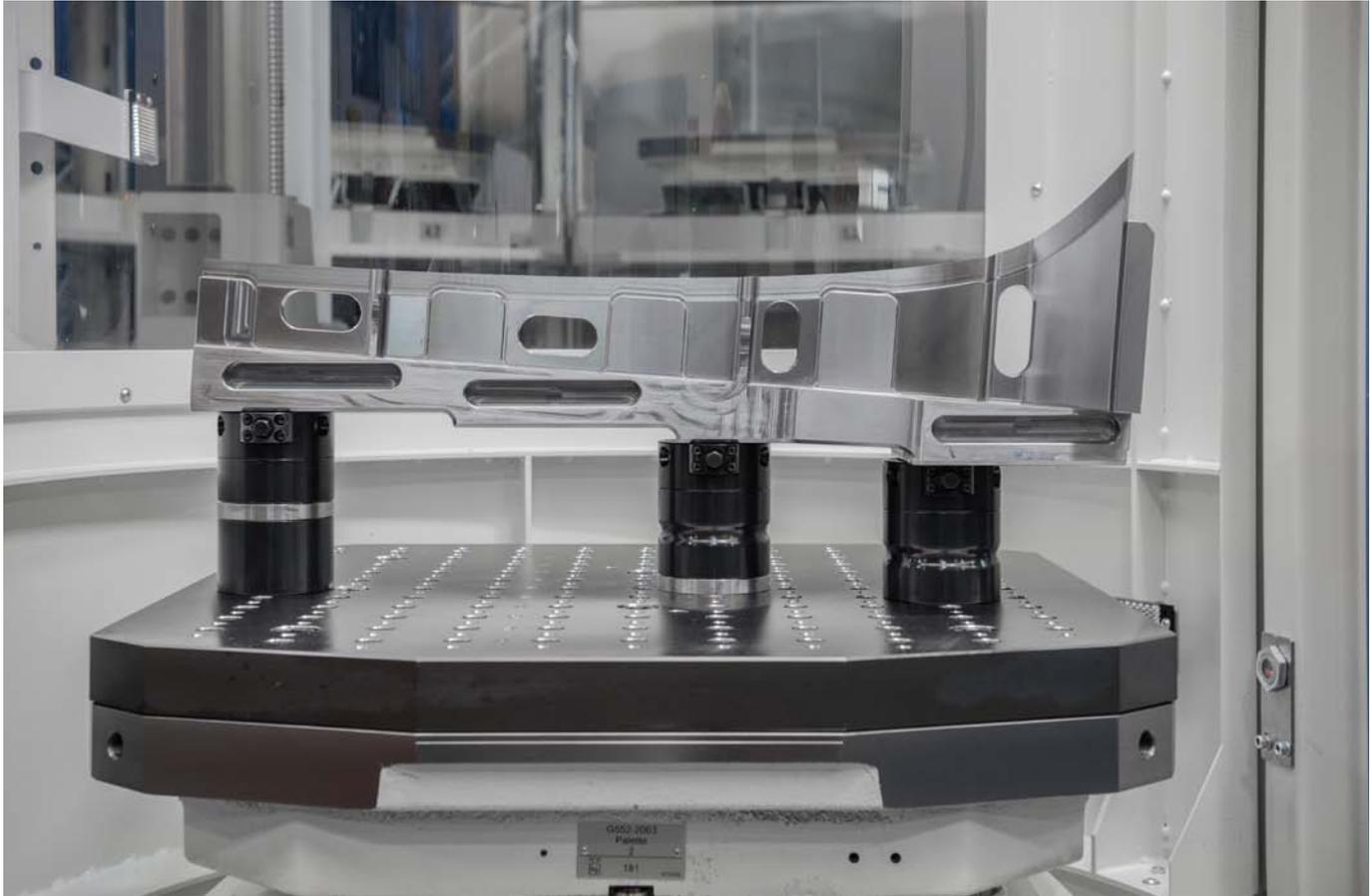
Modulares mechanisches Nullpunktspannsystem im Werkzeug- und Formenbau.
