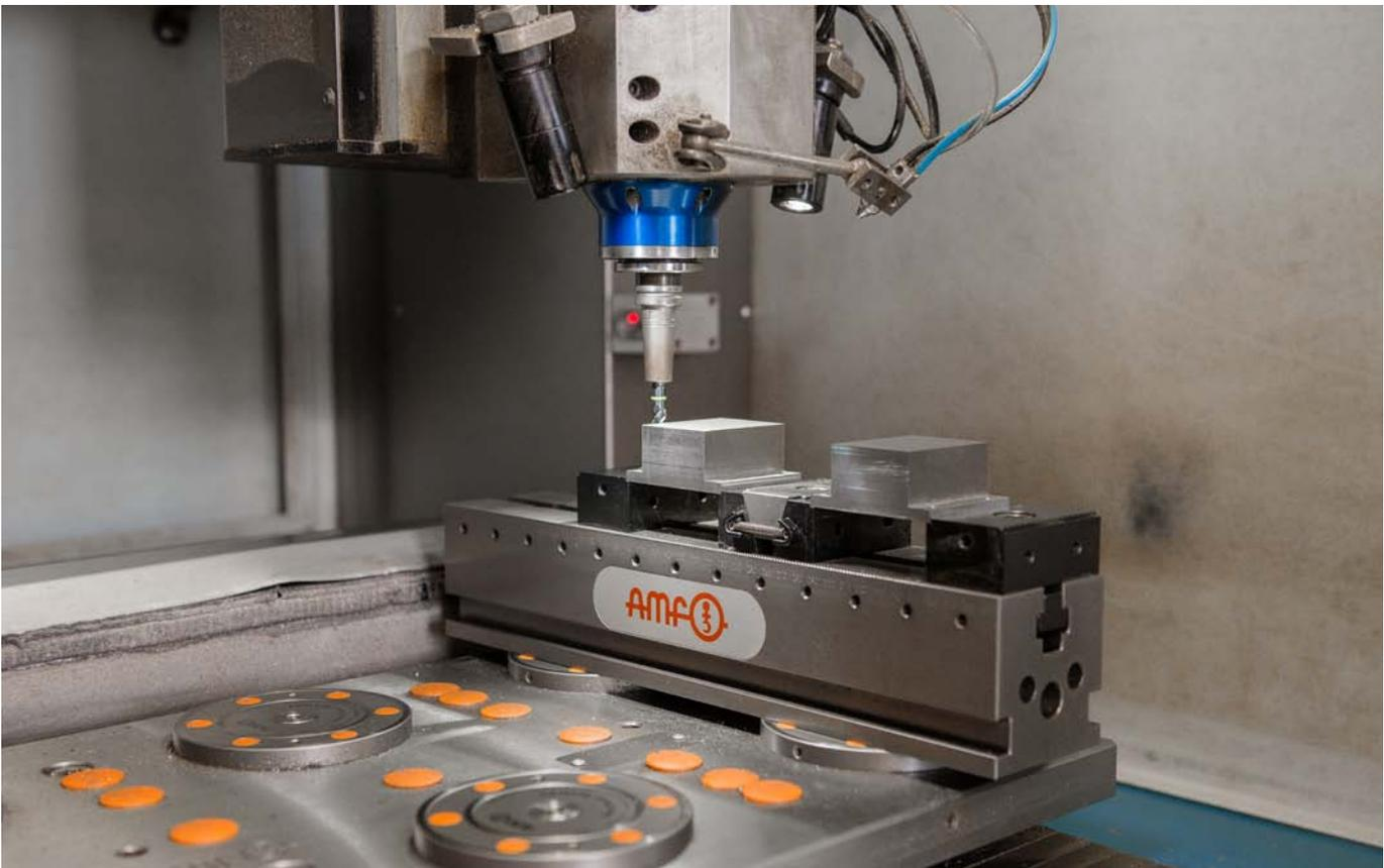
AMF-Mehrfachspannsystem in Kombination mit dem AMF-Zero-Point-System
