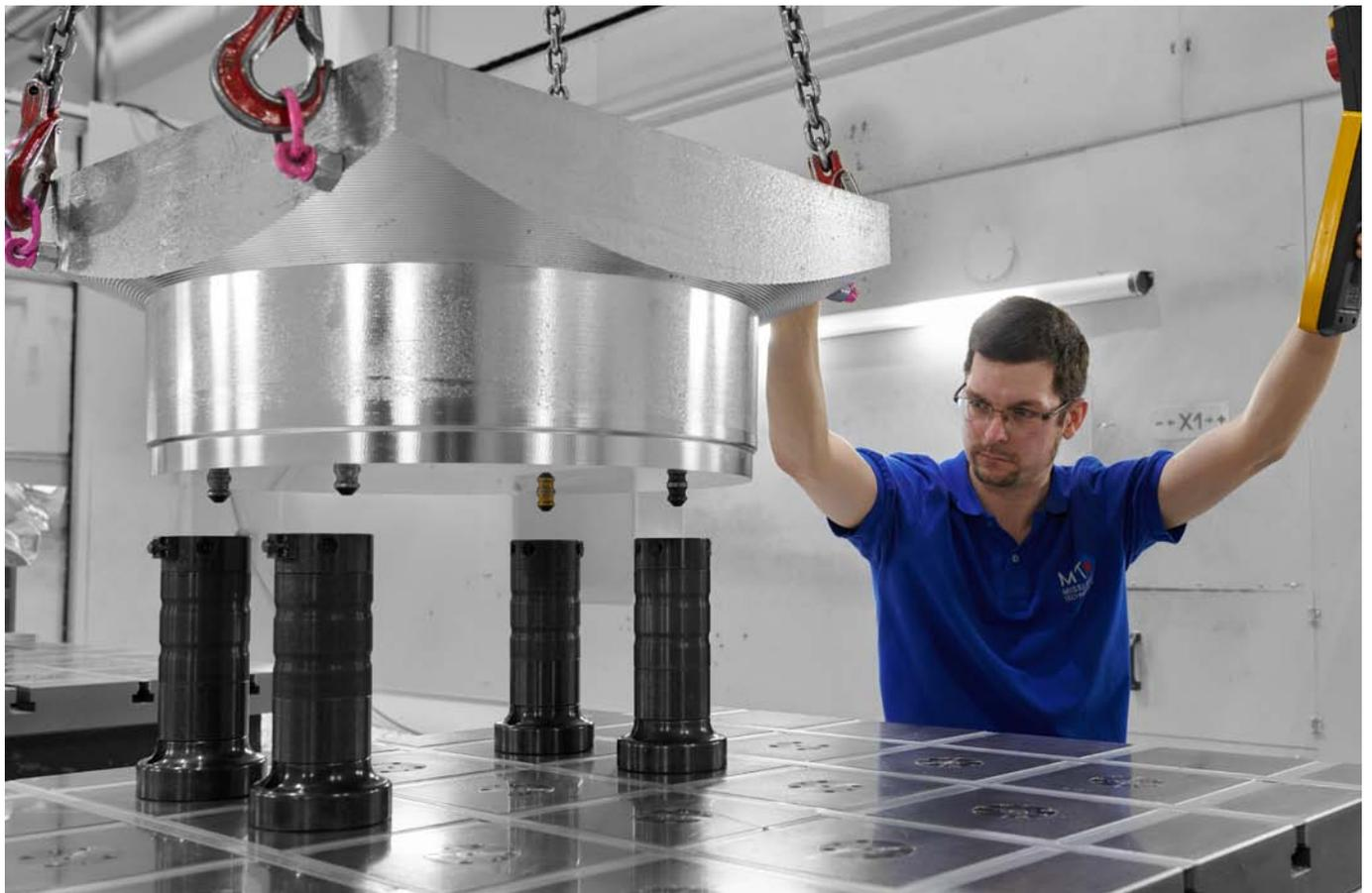
Rüstzeiten mit AMF-Nullpunktspanntechnik minimieren: Mit wenigen Handgriffen ist das Werkstück für die Fünfseitenbearbeitung gespannt.
