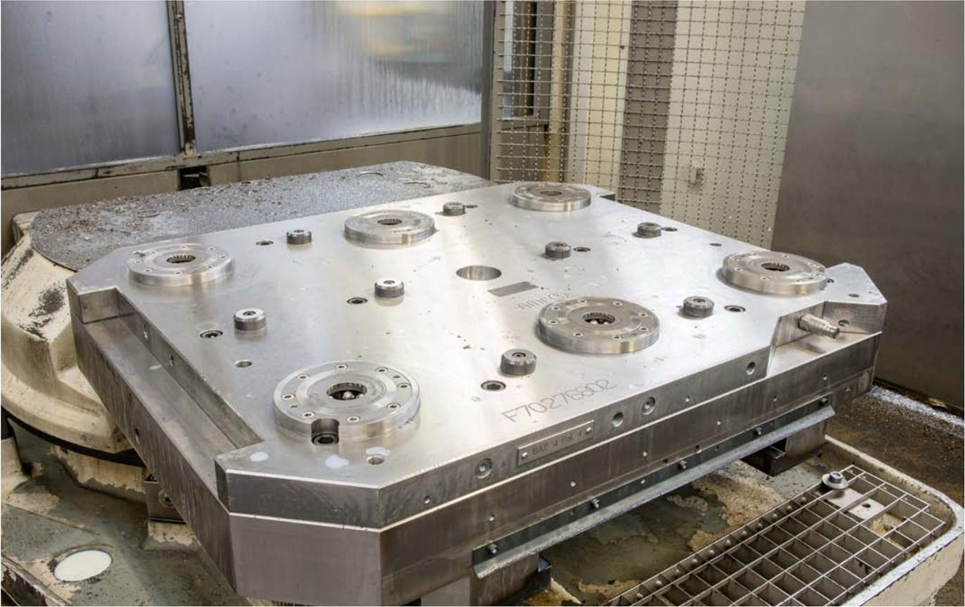
Nullpunktspanntechnik im Einsatz in der Großmotorenfertigung.
