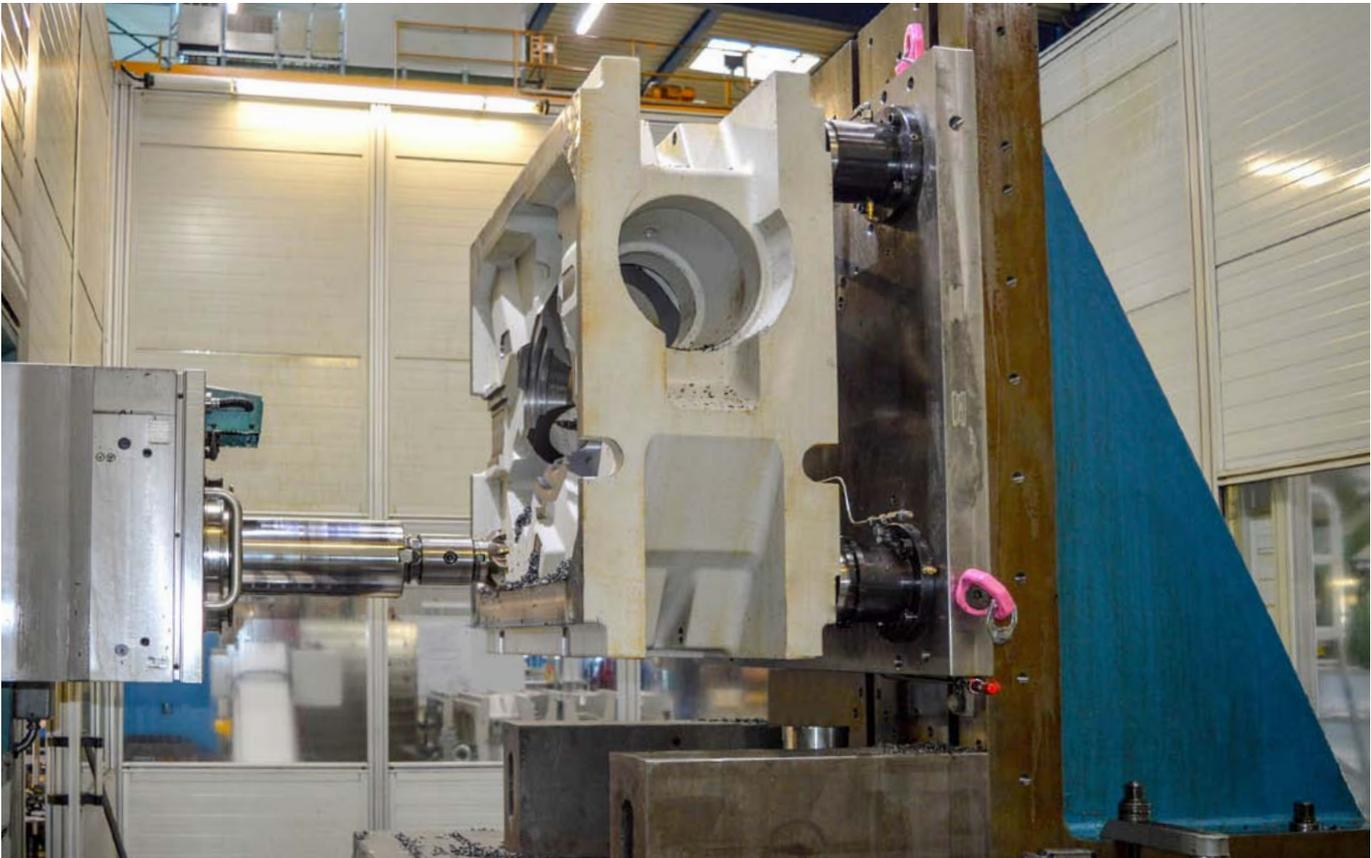
Werkstückdirektspannung auf einem Horizontal-Bearbeitungszentrum.
