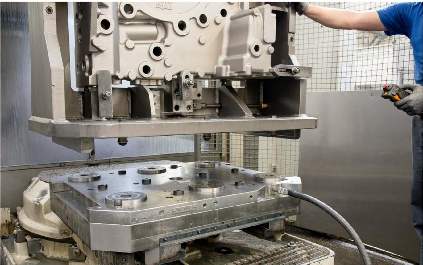
Durch das zwei geteilte Spannbolzensystem mit großem Fangezug und dem kugelkäfigfreien Modulaufbau ist ein ergonomischer Vorrichtungswchsel verkantungsfrei möglich.
