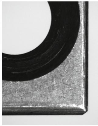
◀ Prinzip einer Auflichtmessung: Hier sind detaillierte Oberflächenmerkmale erkennbar – wie beispielsweise in der Abbildung die Fasse der Bohrung.
