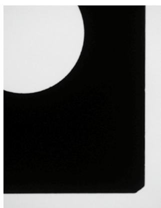
◀ Prinzip einer Durchlichtmessung: Das typische Kamerabild zeigt hohe Kontraste und scharfe Kanten.
