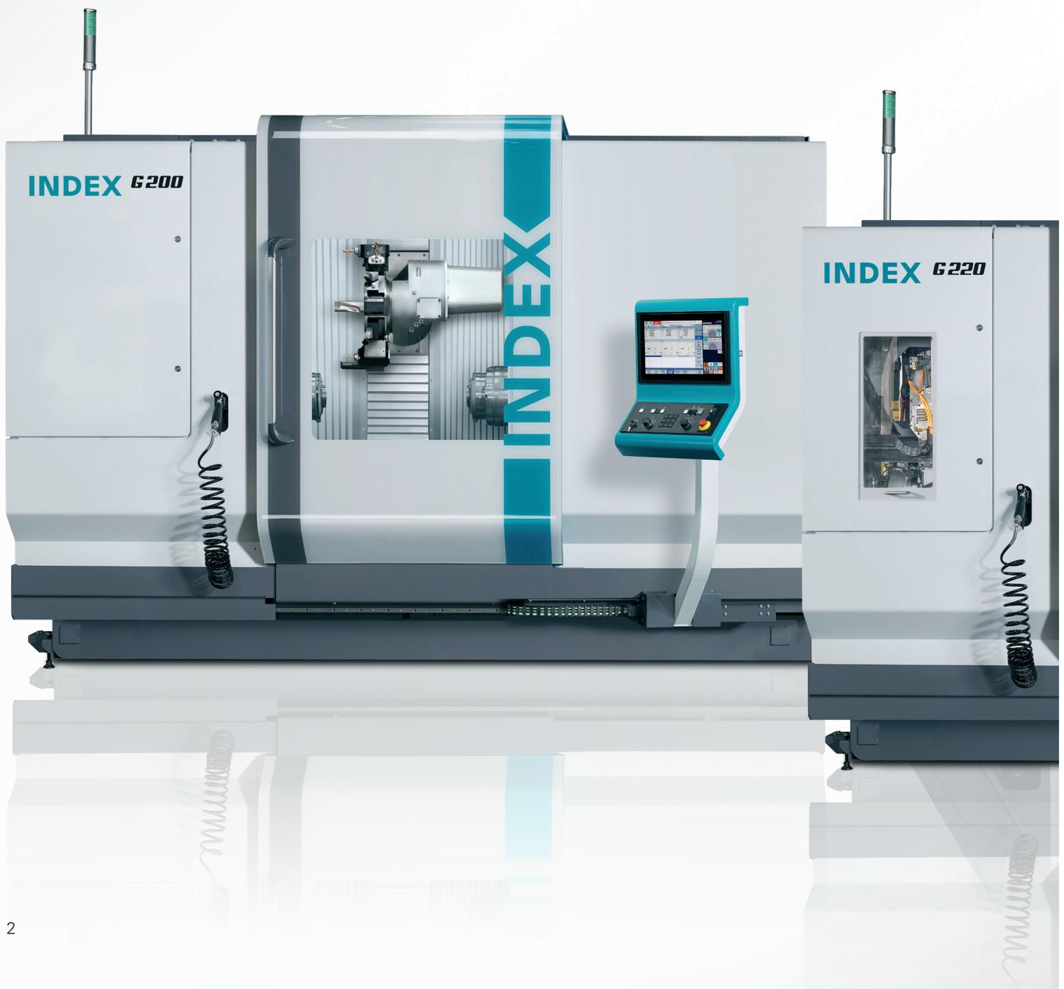
Der großdimensionierte und in dieser Klasse einmalige Arbeitsraum überzeugt mit durchdachten Ausstattungsmerkmalen, die kollisionsunkritisch ein zeitgleiches Bearbeiten mit allen drei Werkzeugträgern ermöglichen.
