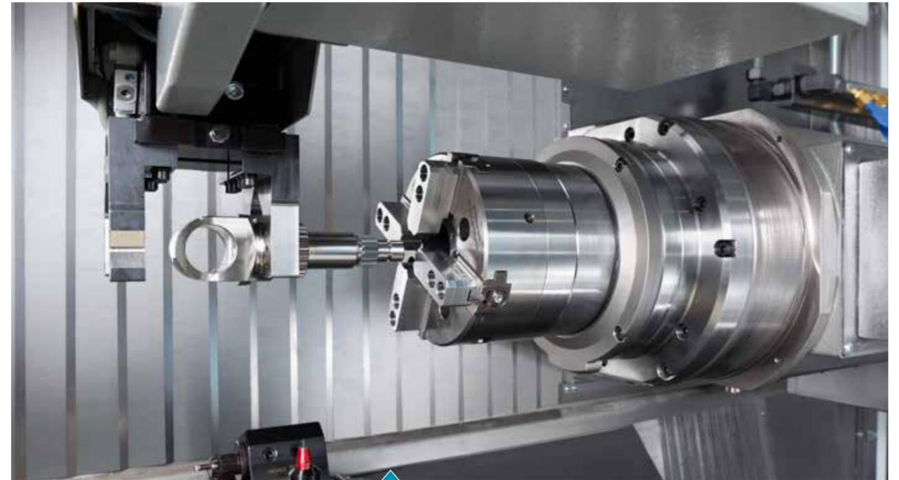
Die integrierte Werkstückhandhabung ist als Option erhältlich. Sie kann gleichermaßen für die Be- und Entladung sowie die Reststückabfuhr eingesetzt werden und ist für Teile bis 10 kg (Einfachgreifer) / 2x10 kg (Doppelgreifer) Gewicht und einem Durchmesser von bis zu Ø 90 mm (Welle) bzw. Ø 230 mm (Flansch) vorgesehen.
