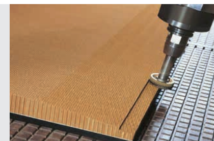
Wabenkernbearbeitung, zum Beispiel zur Versteifung von Flugzeugflügeln.
