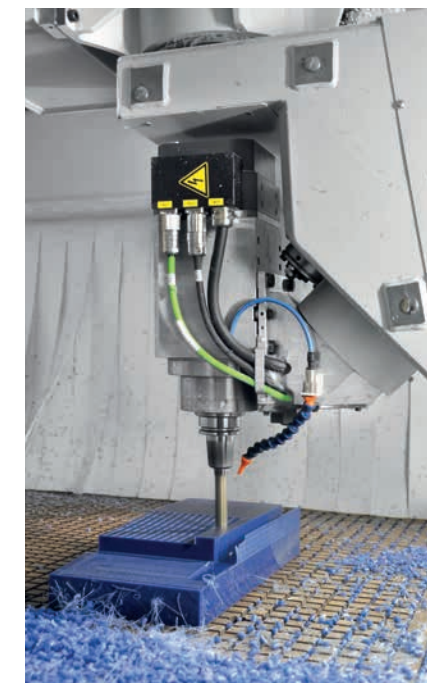
Zerspanung eines Kunststoffteiles (Keil) für die Getränkeabfüllung mit der VISION-I-H, kardanischer 5-Achs-Arbeitskopf, Z-Hub 780 mm.
