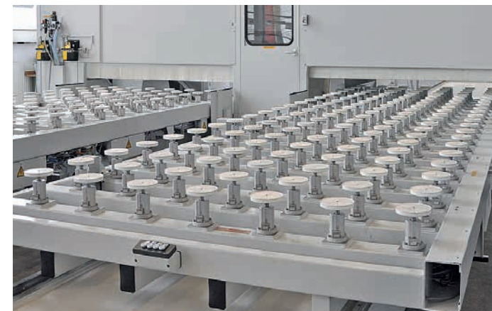
Maschinentische einer ECO mit je 147 Pins zur Aufnahme von Caravan-Wänden.
