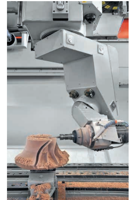
Bearbeitung eines Impellers aus Ureol (Cibatoool) mit einem kardanischen 5-Achs-Arbeitskopf der ECO-NT.
