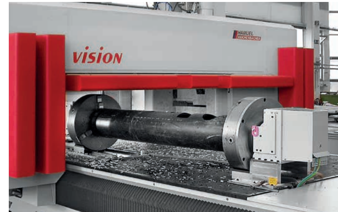
Rohrleitungsbearbeitung auf zusätzlicher NC-Drehachse (bis Ø 600 mm).
