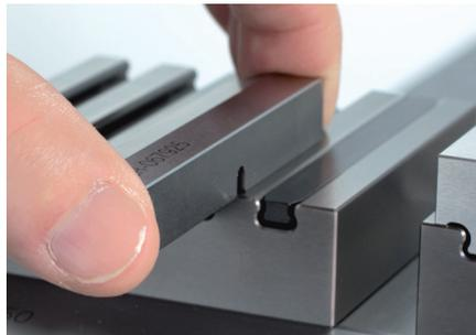
Die Spannbacken können einfach und schnell von Hand ohne jeglichen Einsatz von Werkzeug aufgesetzt werden.
