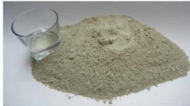
Das Verfüllen kann sowohl im Schweißbetrieb als auch im Präzisionsbetrieb erfolgen. Zur Reinigung werden lediglich Wasser und eine Bürste benötigt. Nach 1 Tag (durfill S) bzw. 4 Tagen (durfill E) kann das Bauteil transportiert werden, nach ca. 14 Tagen erfolgen die Präzisionsbearbeitung und Lackierung.
