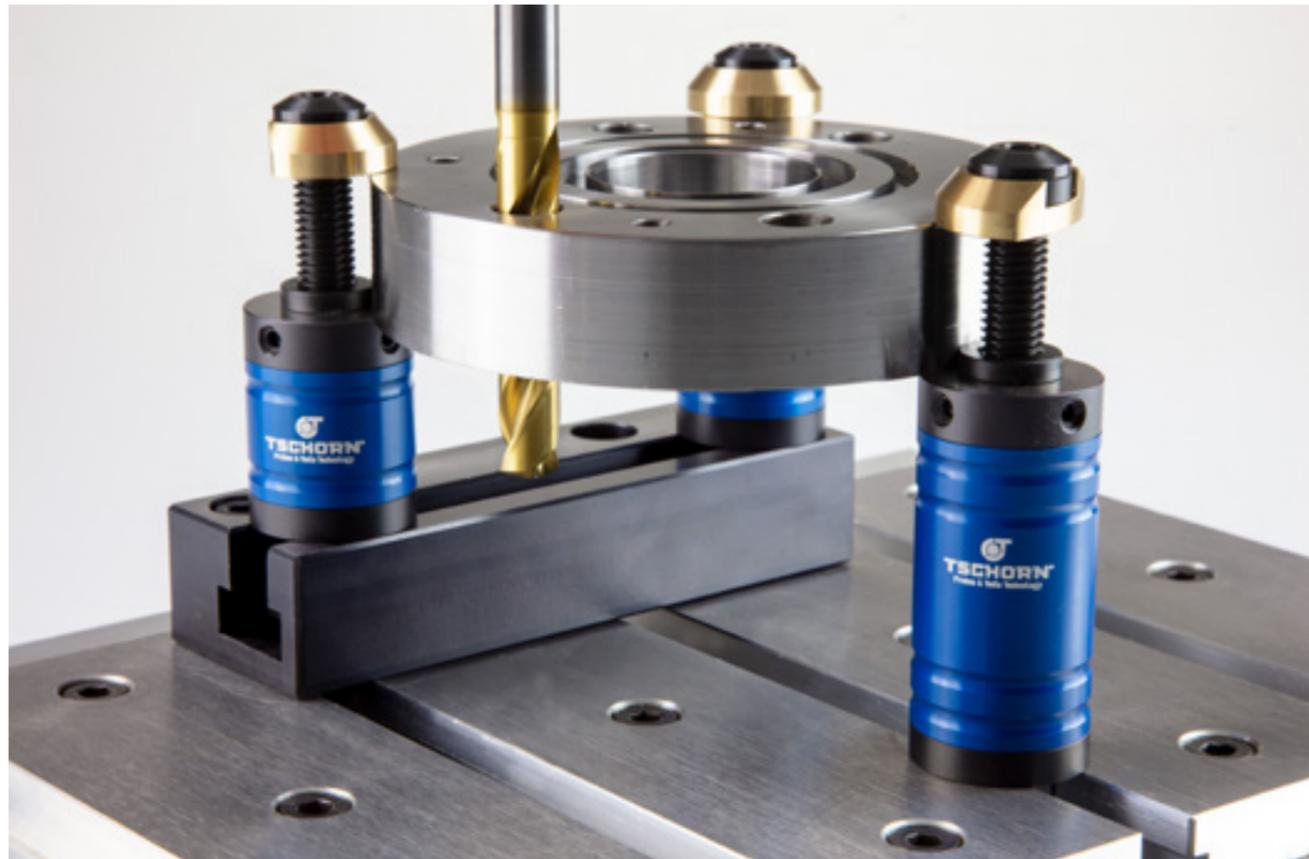
**Schnelles Rüsten zeichnet unsere Aufspannbolzen besonders aus:** schieben Sie die einzelnen Bolzen ohne Spannschraube in die T-Nut des Maschinentisches und positionieren Sie die Bolzen händisch an das Werkstück als Anschlag. Dann ziehen Sie den Aufspannbolzen fest und er dient gleichzeitig als Auflage und zur genauen Positionierung für das Werkstück.
