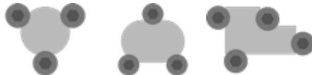
**Sicherer Halt:** die von oben aufgeschraubten Spannschrauben spannen das Werkstück kraftvoll und sicher auf. Ein weicher austauschbarer Messingring verhindert Beschädigungen oder Kratzer am Werkstück.
