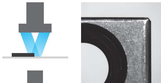
▲ Prinzip einer Auflichtmessung: Hier sind obendrin detaillierte Oberflächenmerkmale erkennbar – wie beispielsweise in der Abbildung die Fase der Bohrung.
